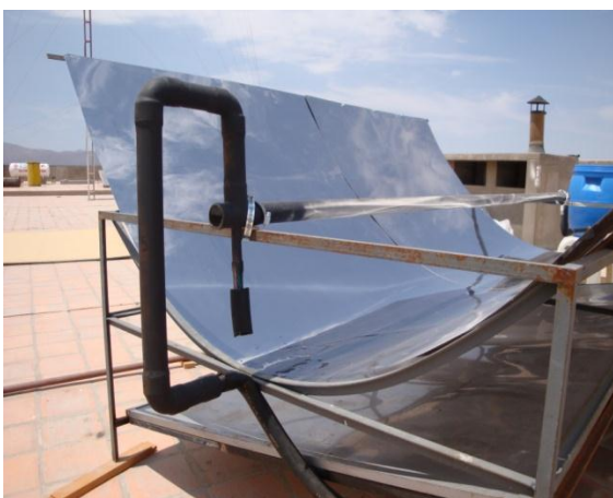
Fig. 5. Vista general destacando detalle de conducción de vapores hacia la placa condensadora
